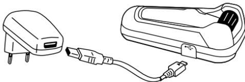
Зарядка с помощью стационарного зарядного устройства происходит намного быстрее, чем через USB-порт компьютера.
